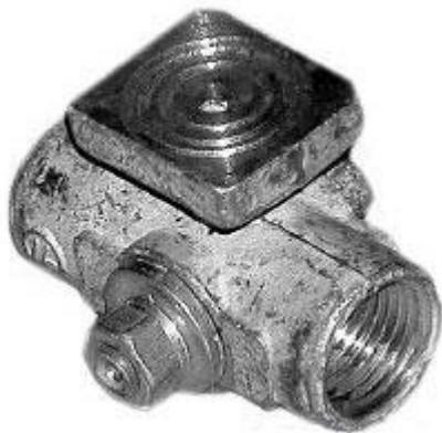
Присоединение к трубопроводу и рабочему манометру — муфтовое по ГОСТ 8724-2002; присоединение к контрольному манометру — фланцевое. На верхнем торце пробки нанесена Т-образная риска, указывающая направление прохода рабочей среды в пробке. Рабочая среда подается в любом направлении, краны на трубопроводе устанавливаются в любом рабочем положении.
