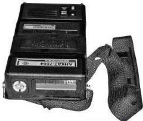
Предназначен для одновременного контроля дозрывоопасной концентрации метана  $\text{CH}_4$ , кислорода  $\text{O}_2$ , окиси углерода  $\text{CO}$  и сероводорода  $\text{H}_2\text{S}$  в ограниченных объемах, на рабочих местах, а также выдачи звуковой и световой предупредительной и аварийной сигнализации при превышении измеряемых параметров.
