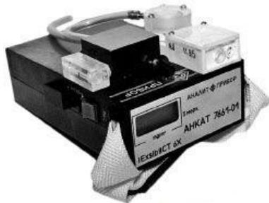
Предназначен для периодического замера меркаптановой серы в природном газе с целью контроля степени одоризации (интенсивности запаха газа), а также качества товарного газа в соответствии с ГОСТ 5542-87. Область применения: на магистральных и распределительных газопроводах, объектах газовых хозяйств.
