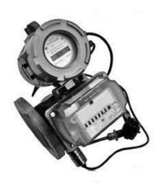
Измерительно-вычислительные комплексы КИ-СТГ предназначены для измерения объема и объемного расхода природного газа в рабочих условиях и автоматического приведения измеренного объема газа к стандартным условиям в зависимости от давления, температуры и коэффициента сжимаемости. Комплексы могут применяться при автоматизированном контроле и учете потребления газа на газораспределительных станциях, газораспределительных пунктах, котельных, промышленных предприятиях и других узлах учета газа.
