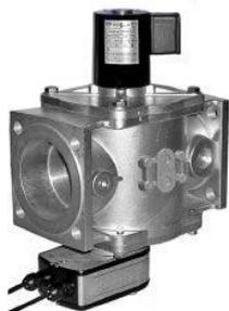
При подаче напряжения электропривод поворачивает заслонку в положение «номинальный расход», ограниченное механическим упором, одновременно растягивая возвратную пружину. В случае отключения напряжения питания пружина возвращает заслонку в положение «промежуточный расход».
