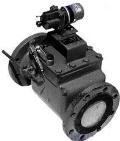
Клапаны с индексом «П» поставляются с электромагнитом переменного тока на 220 В. Срабатывание клапана происходит при прекращении поступления электрического сигнала. Пределы срабатывания не зависят от изменения входного давления. Клапаны могут работать на различных газах.
