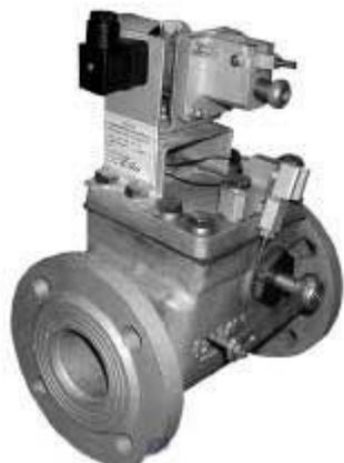
Клапан запорный газовый с электромагнитным приводом на высокое давление КЗГЭМ-ВД предназначен для использования в качестве запорного устройства газопроводных магистралей с рабочей средой в виде углеводородных газов и условным давлением до 1,2 МПа (до 12 кгс/м<sup>2</sup>).
