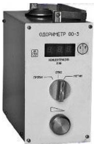
Одориметр ОО-3 предназначен для приготовления газовой смеси при определении органолептическим методом степени одоризации метана или пропан-бутана, используемых для коммунально-бытового потребления.
