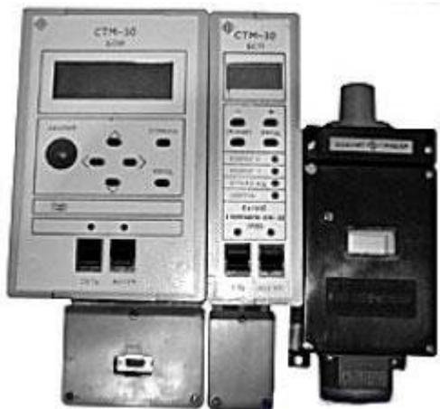
Предназначен для автоматического непрерывного контроля дозрывоопасных концентраций многокомпонентных воздушных смесей горючих газов и паров в процессе нефте- и газодобычи и транспортировки; на объектах газовых и автомобильных хозяйств; на промышленных предприятиях (окрасочные участки, канализация, котельные); на складах ГСМ.
